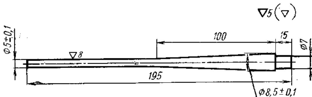
4.4. Технологическая проба волочением должна производиться путем волочения образцов на стане однократного волочения или разрывной машине через фильеру с углом рабочего конуса 15—25° и диаметром калибрующего пояска  $5 \pm 0,2$  мм до разрыва в цилиндрической части, после чего производят замер протянутой части образца.
