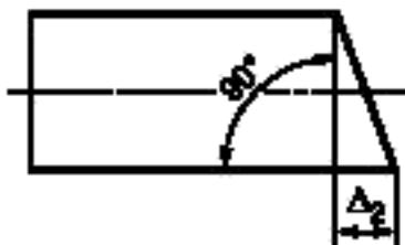
Косину реза ( $\Delta_2$ ) измеряют металлическим угольником по ГОСТ 3749—77, лежащим одной стороной на плоскости расположения слитка, и измерительной линейкой по ГОСТ 427—75. Измерение косину реза проводят на двух торцовых плоскостях.
