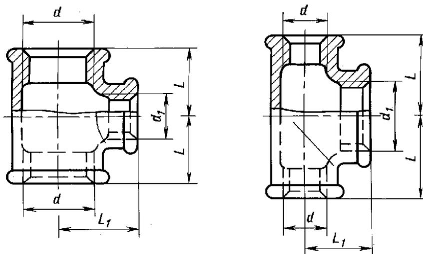
Примечание. Чертеж не определяет конструкцию тройников.
