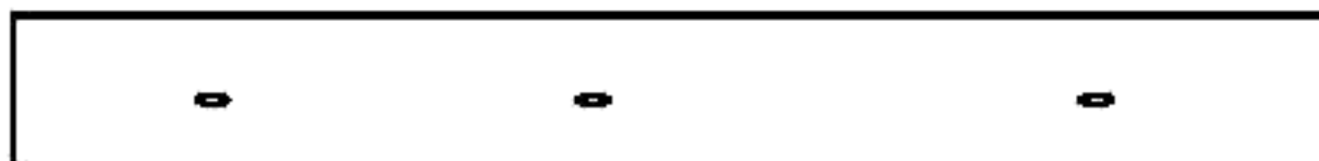
Пример 3 — три несплошности длиной по 3,2 мм
