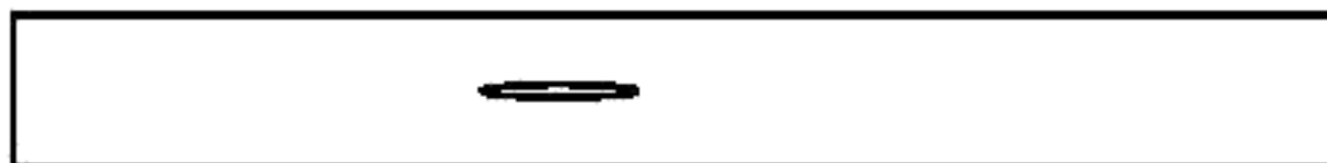
Пример 1 — одна несплошность длиной 12,7 мм
